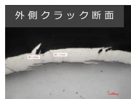
線径 \phi 0.15の白金クラッドタングステン線を \phi 0.3の芯線に巻きつけた時の表面外観観察及び外側断面写真
