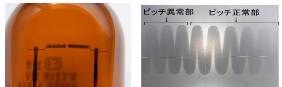
図1 左:短寿命断線電球 右:異常ピッチ部位
