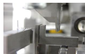
写真2 Mo芯挿入加工
